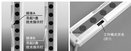
(注1)：照片为8光轴型。除8光轴型以外，工作模式开关安装在本体左侧。
