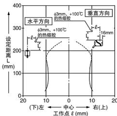
左图为φ3mm、+100℃的热熔胶(放射率0.9)在设定距离160mm、常温(+25℃)条件下通过2级教导进行教导、测定的曲线图。
