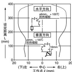
左图为φ6mm、+100℃的热熔胶(放射率0.9)在设定距离300mm、常温(+25℃)条件下通过2级教导进行教导、测定的曲线图。
