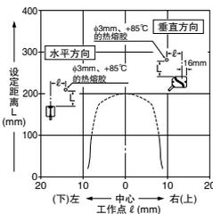
左图为φ3mm、+85℃的热熔胶(放射率0.9)在设定距离100mm、常温(+25℃)条件下通过2级教导进行教导、测定的曲线图。
