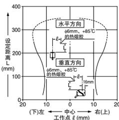
左图为φ6mm、+85℃的热熔胶(放射率0.9)在设定距离250mm、常温(+25℃)条件下通过2级教导进行教导、测定的曲线图。
