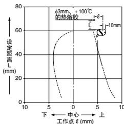
左图为φ3mm、+100℃的热熔胶(放射率0.9)在设定距离40mm、常温(+25℃)条件下通过1级教导进行教导、测定的曲线图。
