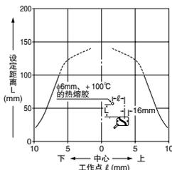
左图为安装附带狭缝透光罩、φ6mm、+100℃的热熔胶(放射率0.9)在设定距离100mm、常温(+25℃)条件下通过2级教导进行教导、测定的曲线图。
